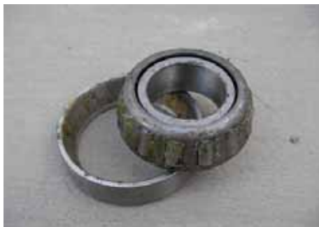
Ein schadhaftes Lenkkopflager: Die Kegellager sind mit altem Fett verharzt, die Lagerpfanne zeigt Unebenheiten. Foto: Olaf Hagelstein
