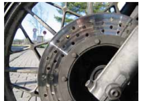
Riefe und Risse bedeuten: Neue Bremsscheiben müssen montiert werden. Foto: Christian Gasche
