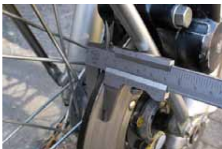
Mit dem Messschieber wird die Höhe der Bremsscheibe gemessen. Foto: Olaf Hagelstein
