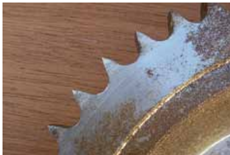
Neues Kettenrad mit gleichmäßigen Zähnen. Foto: Olaf Hagelstein
