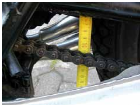
Mit einem Zollstock wird das Kettenspiel gemessen. Foto: Olaf Hagelstein
