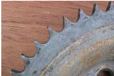
Altes Kettenrad: Spitze und einseitig abgenutzte Zähne. Foto: Olaf Hagelstein
