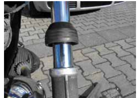
Wenn unter der Staubkappe oder auf dem Gabelholm Öl zu bemerken ist, ist der Dichtring schadhafte und muss ausgetauscht werden. Foto: Christian Gasche
