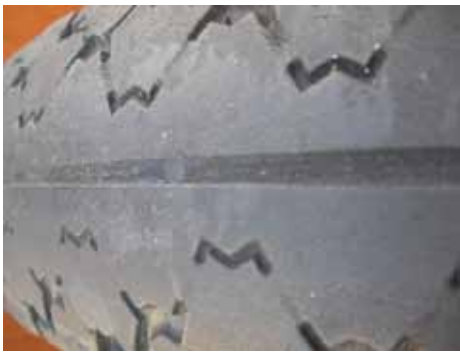
In der Mitte ist das Profil über die Verschleißmarke abgefahren. Foto: Olaf Hagelstein
